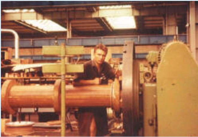
Feb. 1962 vor Beginn der Firmengründung KommR. Josef Mehler bei Brown Boveri wickeln einer Transformatorspule
